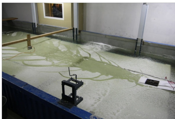
Рис. 1. Характер разрушения модельного льда при движении одной модели
