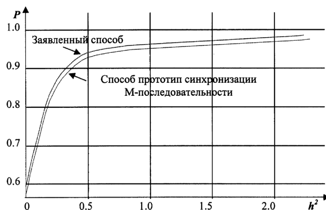
Рис. 3. Зависимость вероятности правильного приема элементов псевдослучайной последовательности от соотношения сигнал/шум
