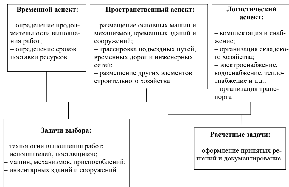
Рис. 1. Декомпозиция основных задач организационно-технологического проектирования
