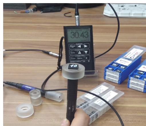
Рис. 2. Измерительное устройство значения структурных параметров режущей керамики: 1 – измерительное устройство; 2 – преобразователь сигнала; 3 – режущая пластинка
