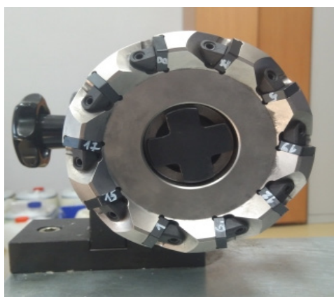
Рис. 4. Торцевая фреза с установленными режущими пластинами после отбора
