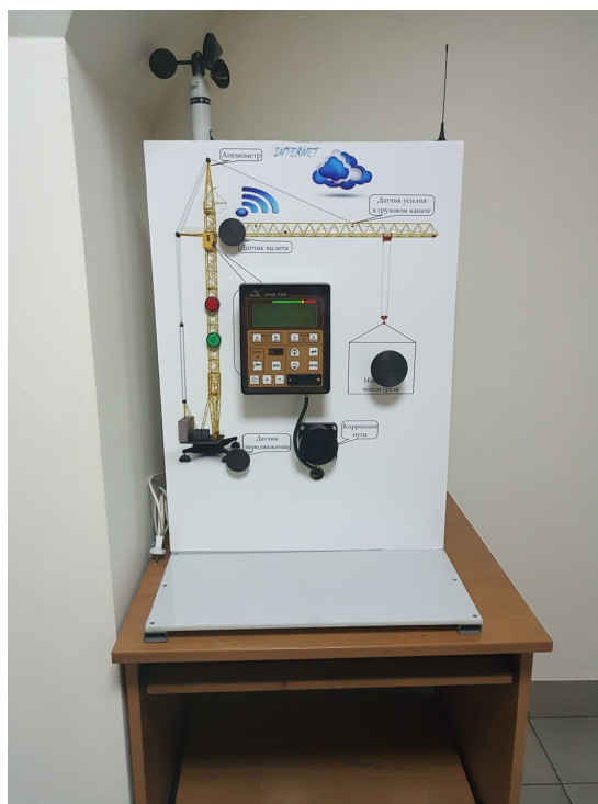
Рис. 5. Действующая модель дистанционного мониторинга оценки риска для риск-ориентированного подхода при эксплуатации башенного крана
