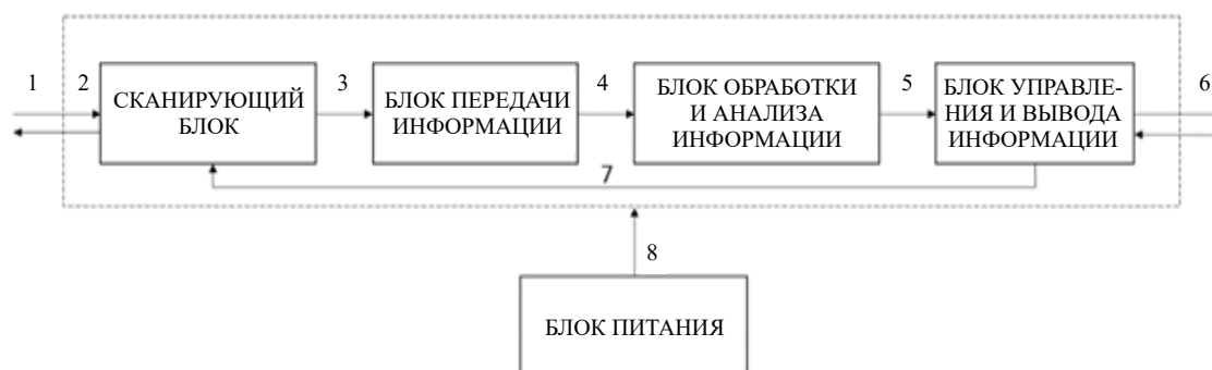
Рис. 1. Функциональная схема дефектоскопа «Авикон»
