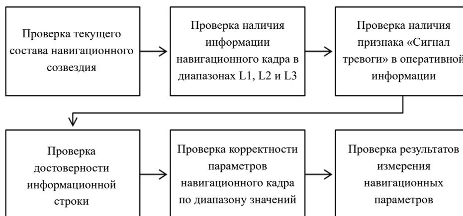
Рис. 1. Процедура контроля достоверности навигационных сообщений наземного комплекса управления системой ГЛОНАСС
