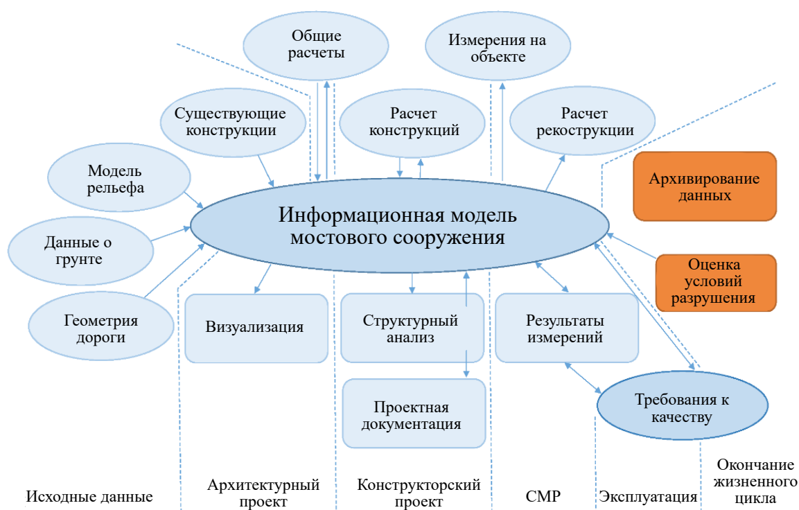
Рис. 3. Структурная схема информационной модели мостового сооружения
