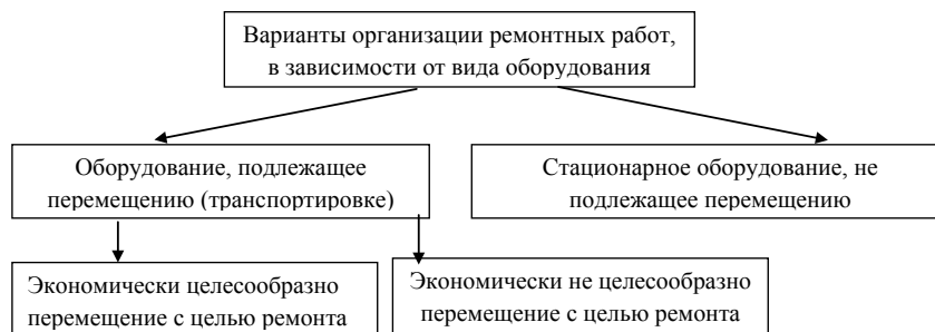
Рис. 1. Варианты организации ремонтных работ оборудования предприятий нефтегазового комплекса
