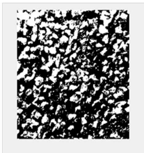
Рис. 4. Результат отсечения по порогу яркости
