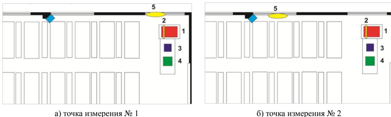
**Рис. 1.** Схема измерения ПЭМИН: 1 – системный блок; 2 – монитор; 3 – спектроанализатор; 4 – комплекс «Навигатор»; 5 – активная антенна
