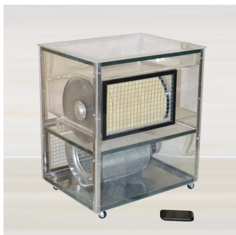
Рис. 2. Роторный пластинчатый теплообменник РПТМ
