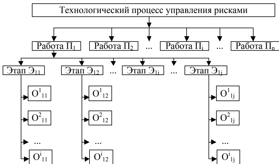
Рис. 1. Декомпозиция технологического процесса на уровне работ, этапов и операций
