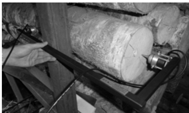
Рис. 2. Приспособление для выполнения угловых измерений с применением стандартных преобразователей прибора «Пульсар» – угольник для продольно-поперечного прозвучивания
