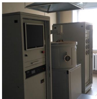
Рис. 4. Установка для нанесения покрытий на фрезы
