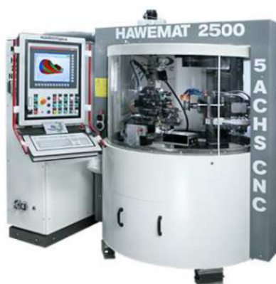
Рис. 3. Внешний вид станка для формирования режущей части инструмента
