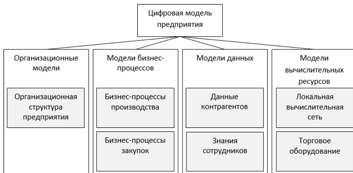
Рис. 1. Фрагмент структуры цифровой модели предприятия
