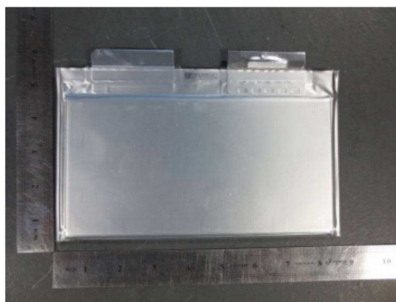
Рис. 10. Аккумулятор DCF021EA 3,7В 21А * ч
