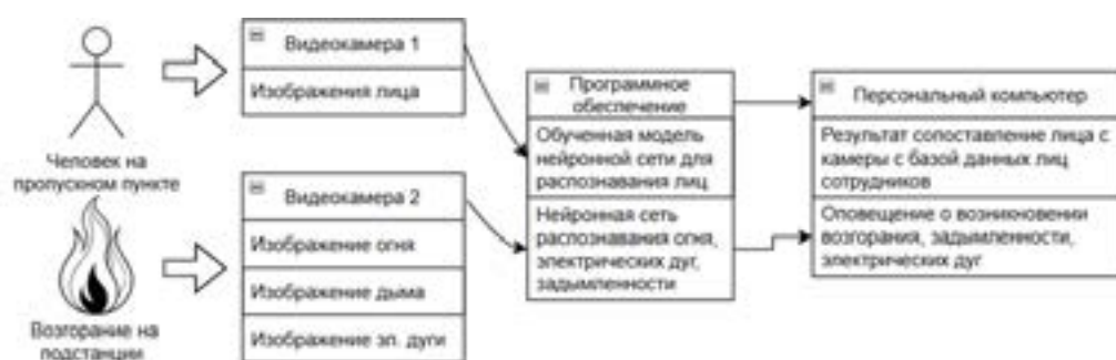
Рис. 2. Структурная схема лабораторного стенда для удаленного контроля подстанции
