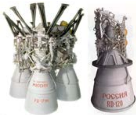
Рис. 1. Примеры компактного расположения трубопроводов со сложной пространственной геометрией на ракетных двигателях
