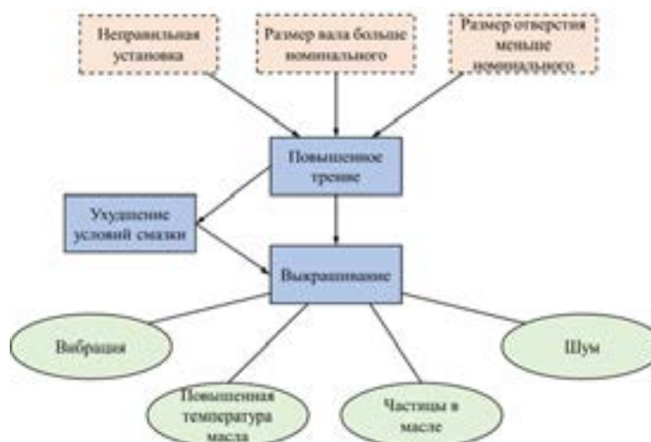
Рис. 4. Дерево причинно-следственных связей для процесса выкрашивания подшипника качения выносной опоры барабана механизма главного подъема
