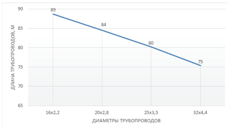
Рис. 3. Зависимость изменения длины трубопровода от его диаметра, при прочих равных условиях
