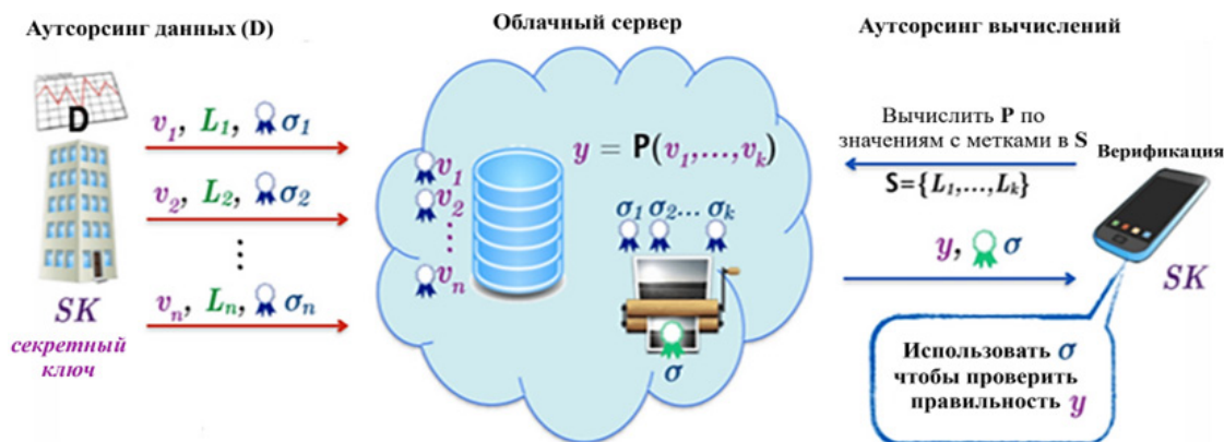
Рис. 3. Схема свободно-шумного полностью гомоморфного шифрования [9]
