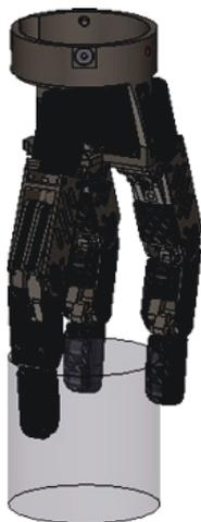
Рис. 5. Захват ОМ с помощью ЗУ
