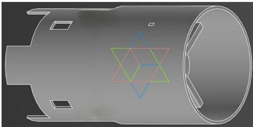
Рис. 1. 3D-модель хвостовой части ракеты, разработанная с помощью программы Компас-3D
