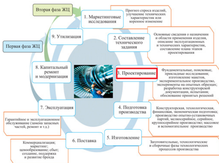
Рис. 1. Схема жизненного цикла продукта (изделия) машиностроения [1]
