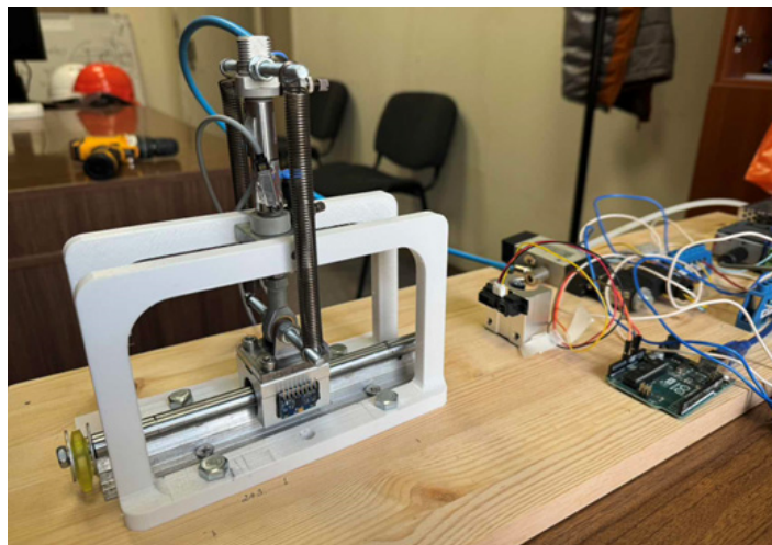
Рис. 2. Макет мехатронного пневматического привода с нелинейным пружинным аккумулятором
