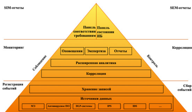
Рис. 1. Обобщенная архитектура SIEM-системы
