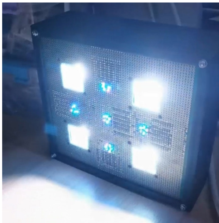
Рис. 1. Имитатор солнечного излучения
