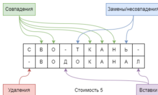
Рис. 1. Схема односимвольных операций в методе расстояния Левенштейна
