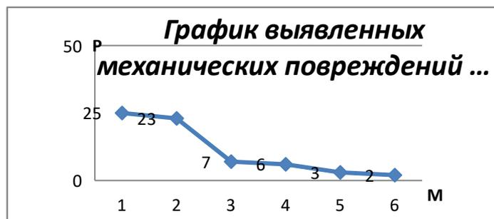
**Рис. 1.** Статистика выявленных повреждений и отказов по основным элементам (систем) блока механических повреждений. В блок механических повреждений (М) входят повреждения: 1 – механизма хода; 2 – кузова; 3 – рамы; 4 – двигателя внутреннего сгорания; 5 – кабины; 6 – передней балки
