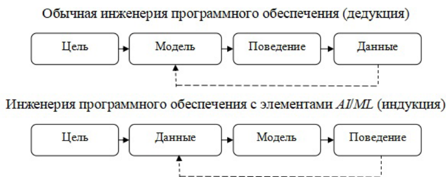
Рис. 2. Разница в процессах инженерии обычного программного обеспечения и программного обеспечения с элементами AI
