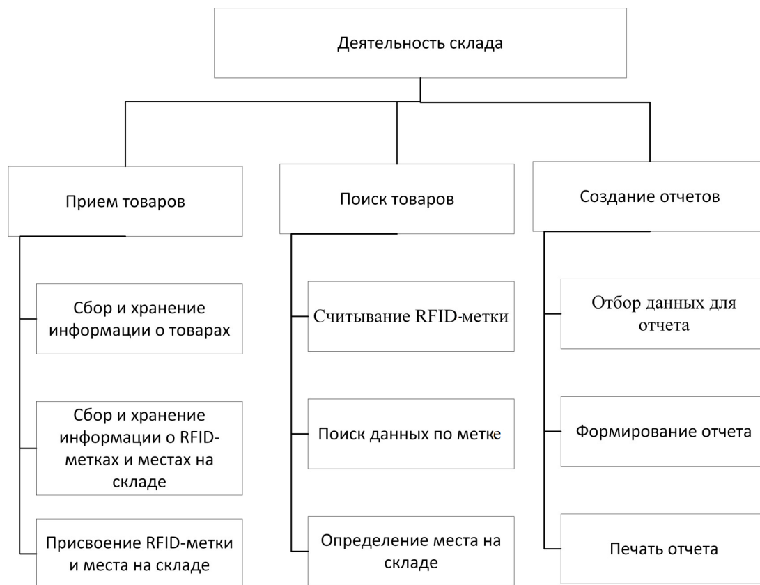
Рис. 1. Функциональная структура складского помещения
