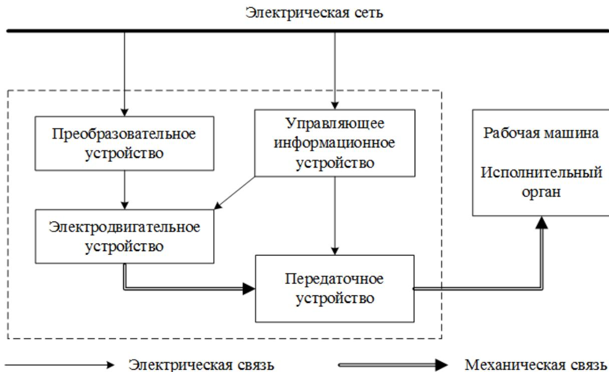
Рис. 1. Структурная схема электропривода
