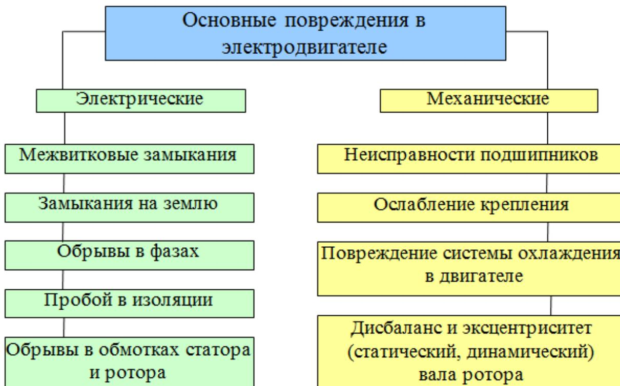
Рис. 2. Основные виды неисправностей в электродвигателе
