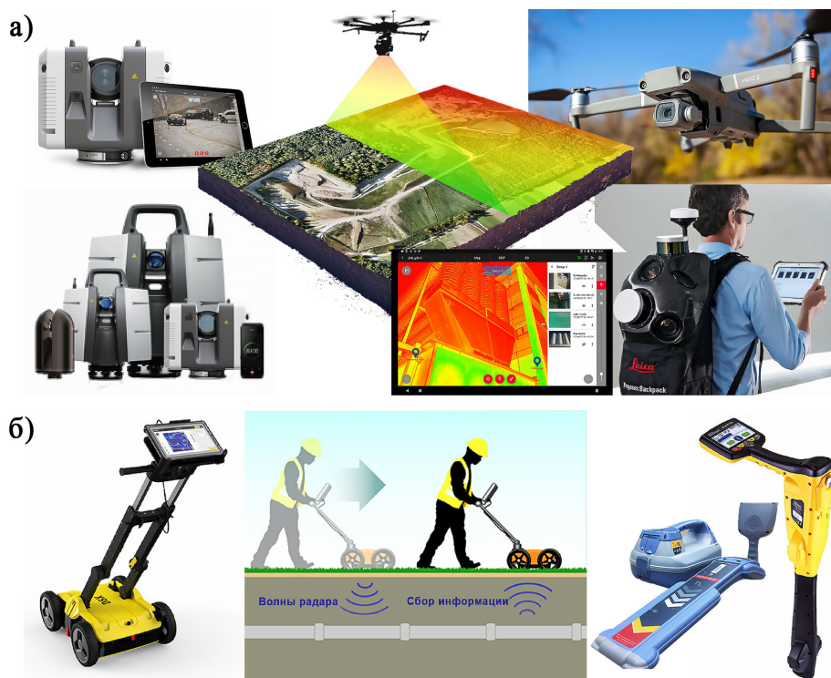
Рис. 3. Технологии сканирования сетей и сооружений водоснабжения и водоотведения: а) лазерные сканеры и устройства на их основе для наружной и внутренней съемки; б) георадары и электромагнитные регистраторы для подземной съемки
