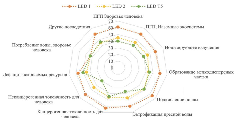
Рис. 1. Оценка воздействия жизненного цикла исследуемых бытовых светодиодных ламп
