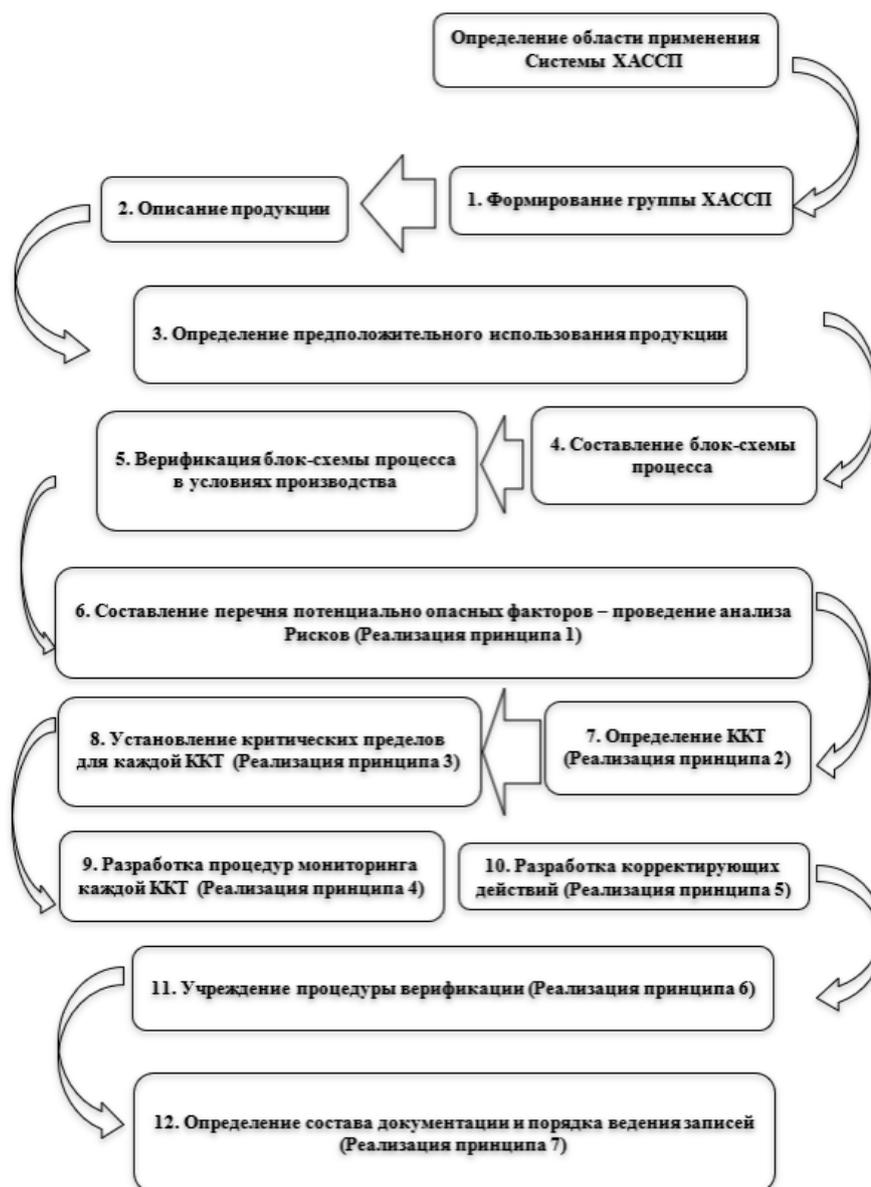
Рис. 1. Шаги разработки системы ХАССП
