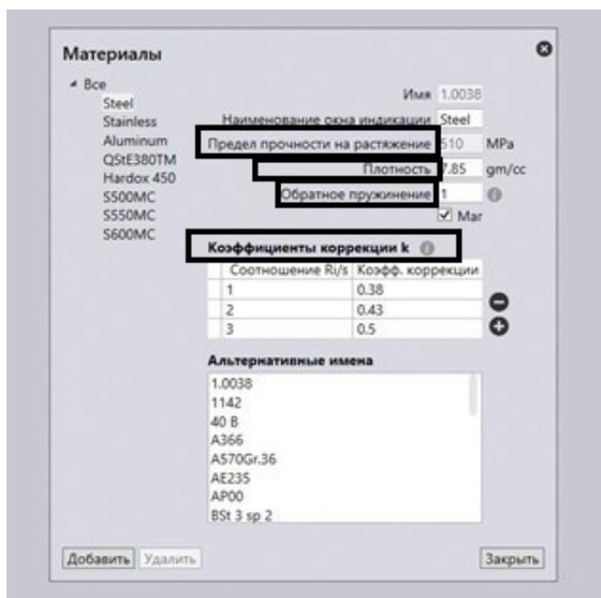
Рис. 3. Факторы, учитываемые в программе *Metamotion Flux* при разработке технологического процесса
