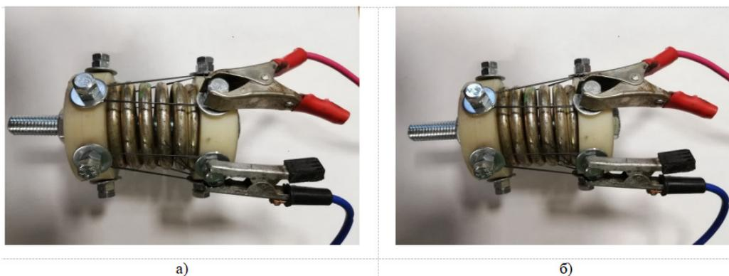
Рис. 3. Экспериментальный привод: а) при холодных элементах из СПФ; б) при нагреве элементов из СПФ
