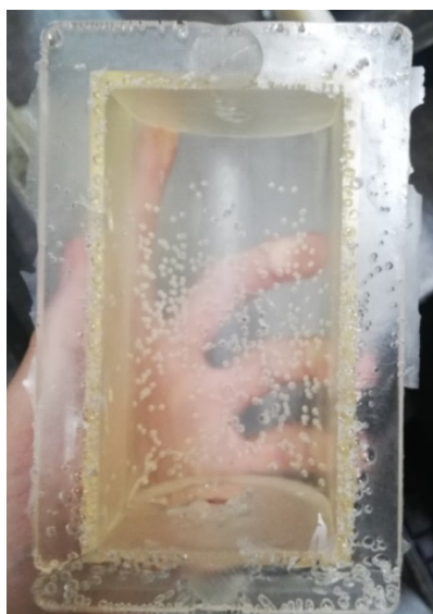
Рис. 4. Изделие после заливки неудачно вакуумированной смеси
