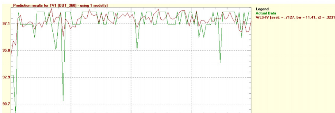
Рис. 4. Результат наложения данных модели выхода до 360 °С в керосино-дизельной фракции на архивные лабораторные данные
