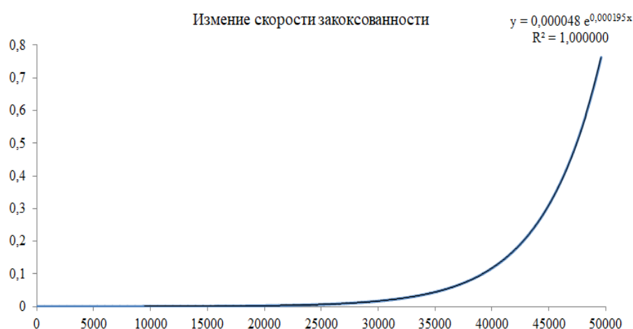
Рис. 2. Изменение скорости коксообразования в зависимости от времени эксплуатации печи пиролиза
