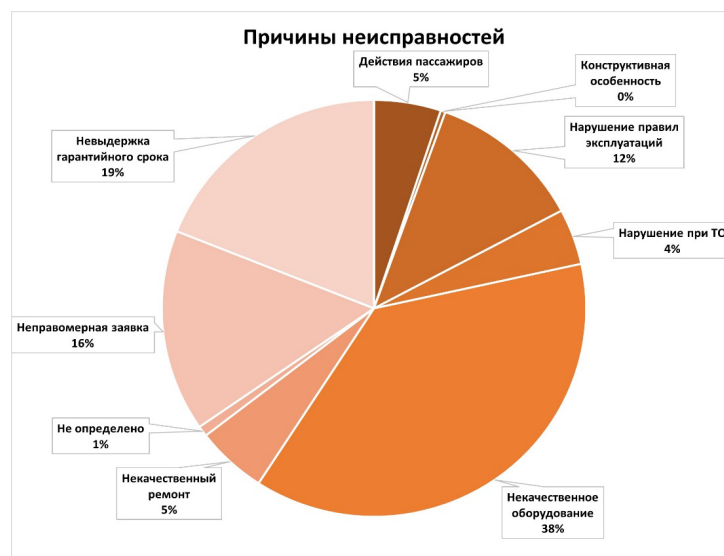
Рис. 2. Структура причин неисправностей в пассажирских вагонах дальнего следования
