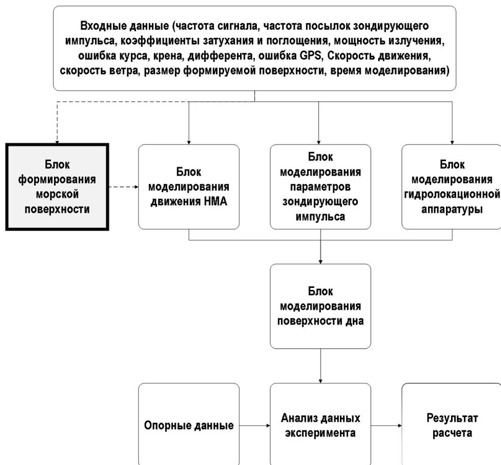
Рис. 1. Структурная схема разработанной имитационной модели
