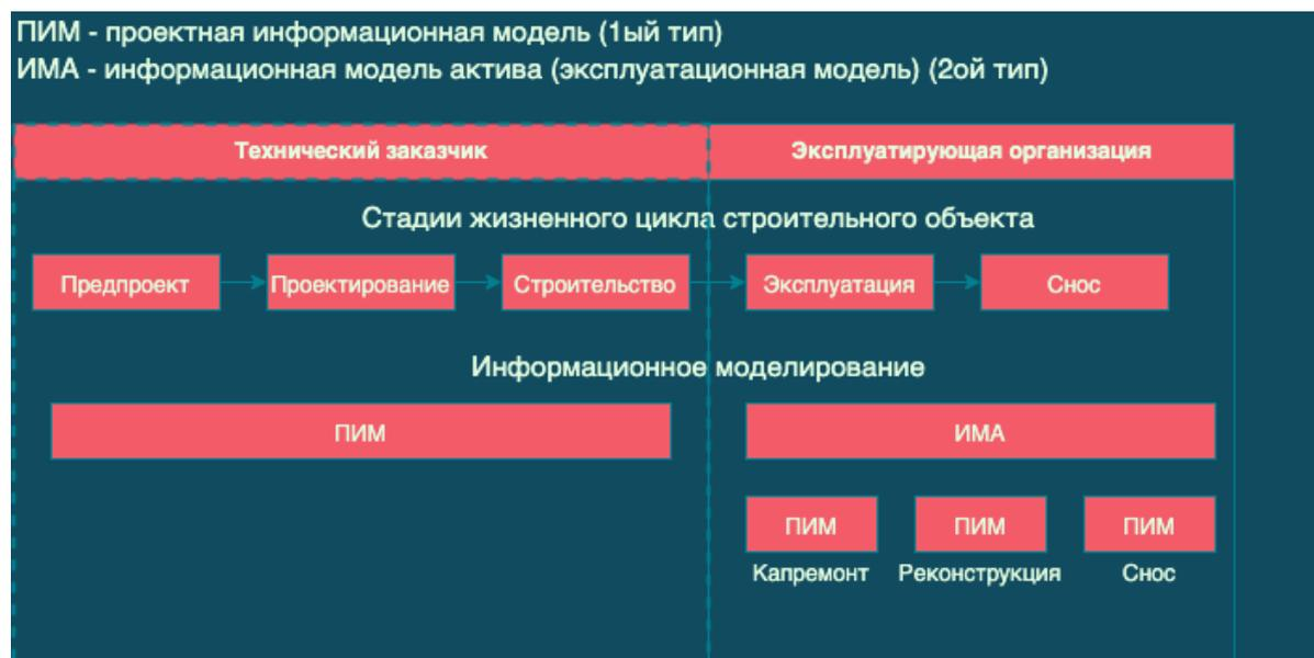
Рис. 1. Два типа информационных моделей объекта строительства (согласно международным стандартам PAS-1192-3:2013 и ISO 19650)
