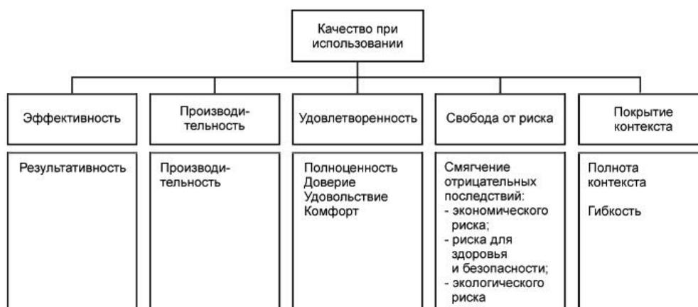
Рис. 3. Модель качества при использовании, приведенная в ГОСТ Р ИСО/МЭК 25010-2015 [10]
