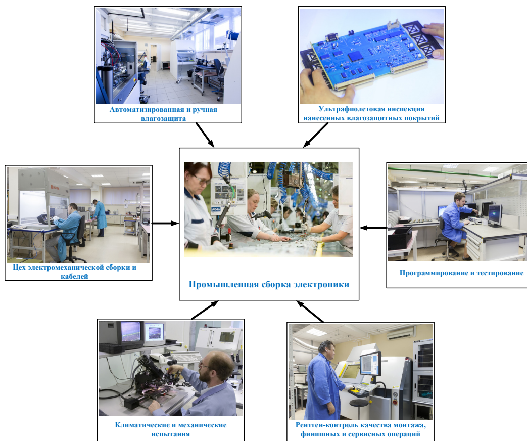
Рис. 2. Технологические этапы производства электронных модулей
