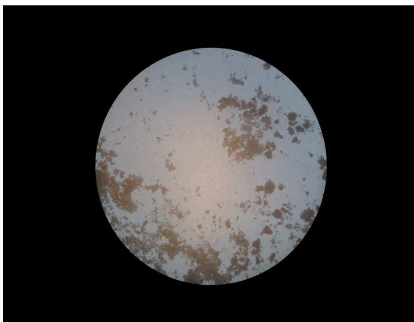
Рис. 2. Микрофотография структуры опоки (фракция 2 мм, прокалка при температуре 120 °С)
