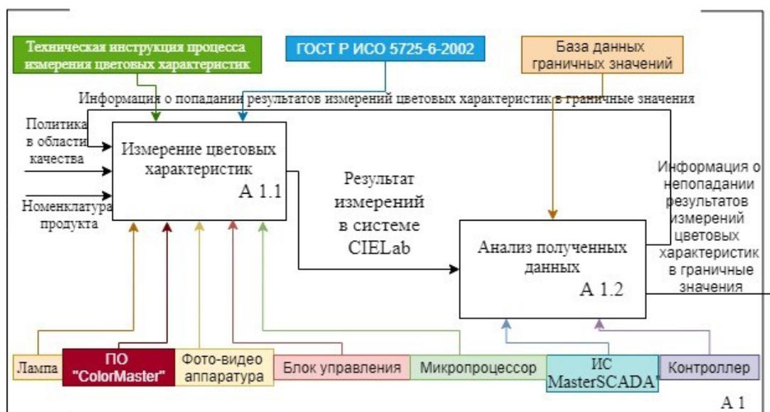
Рис. 2. Модель контроля качества копченой рыбной продукции
