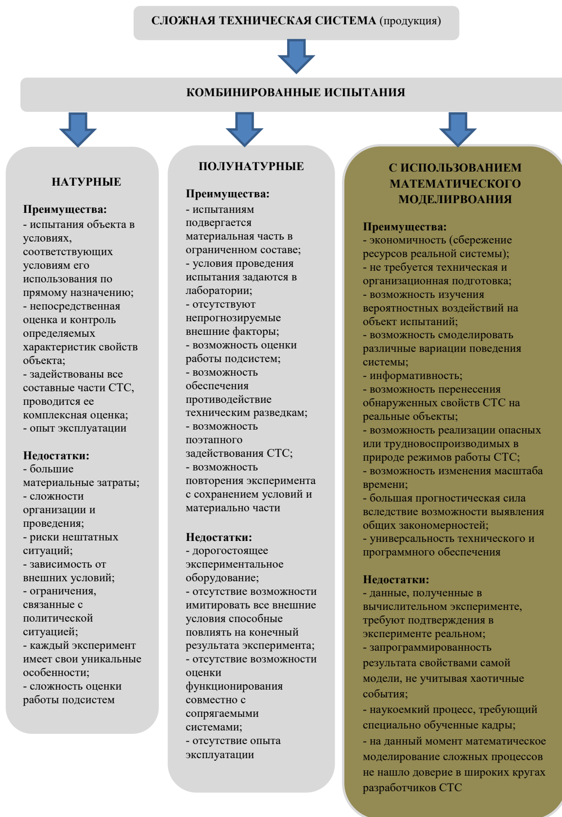
Рис. 1. Пример организации комбинированной системы испытаний
