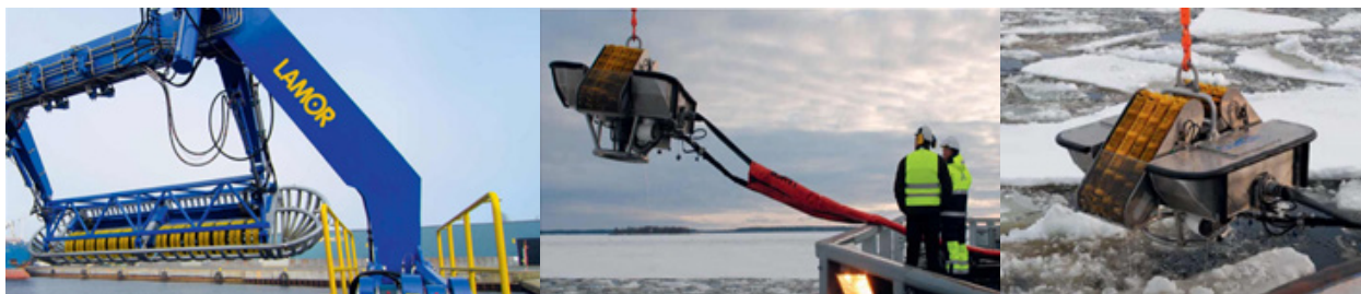
Рис. 1. Арктический нефтесборщик Sternmax
