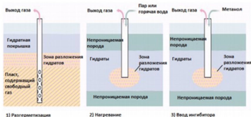
Рис. 2. Основные методы добычи газогидратов [4]
