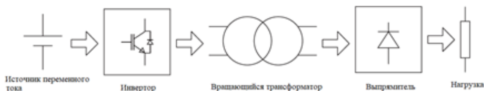
Рис. 2. Топология с однофазным вращающимся трансформатором
