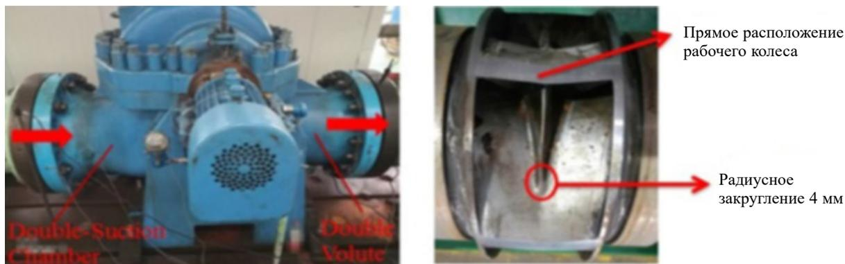
Рис. 1. Опытный образец насоса с рабочими колесами в прямом расположении
