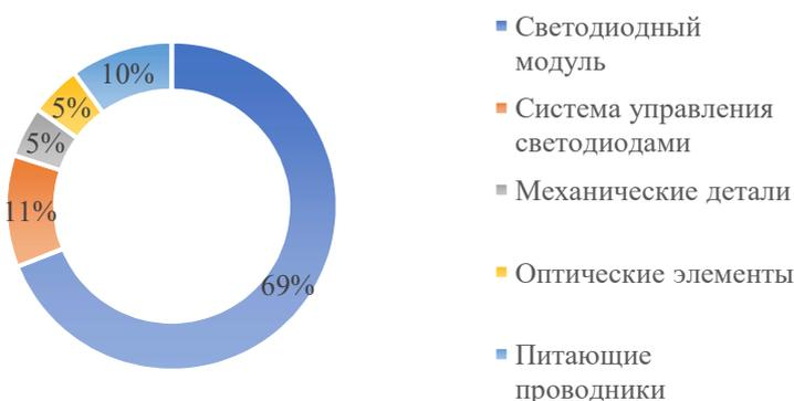
Рис. 2. Процентное распределение каждого модуля типового СОП
