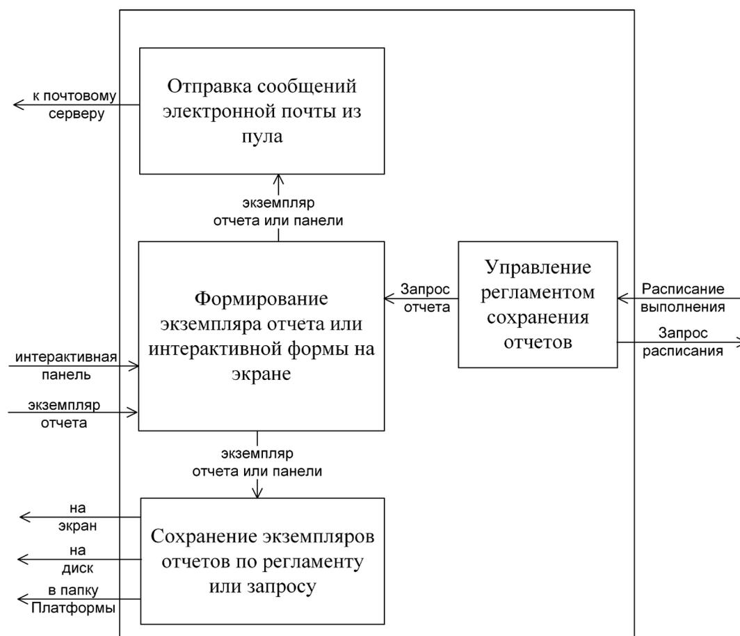
Рис. 5. Структурная схема компонента выгрузки
