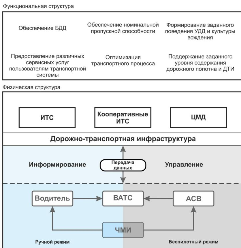
**Рис. 5.** Физическая и функциональная структура дорожного движения с участием беспилотных транспортных средств на автомобильных дорогах общего пользования (логистических пространствах)
