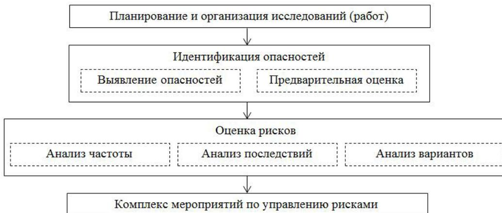
**Рис. 2.** Алгоритм прогноза последствий проявлений негативных факторов строительного производства
