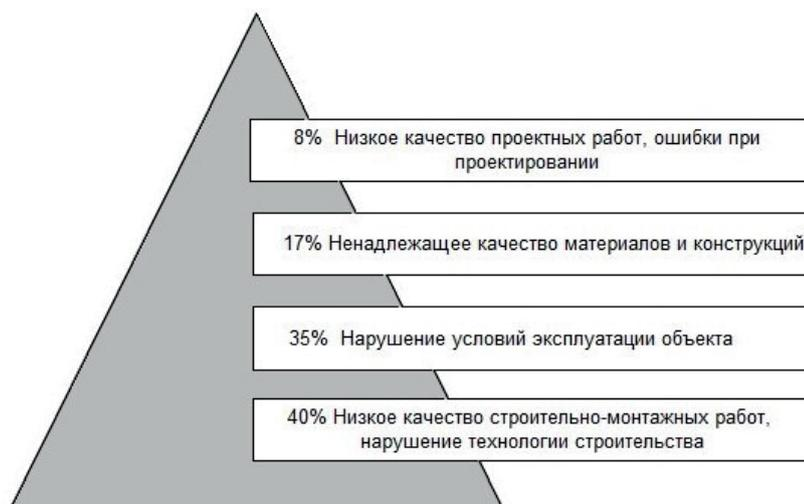
Рис. 1. Причины обрушения зданий и сооружений
