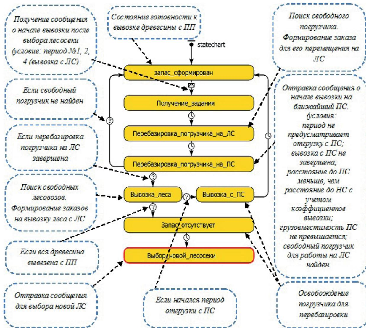
Рис. 1. Диаграмма состояний реализации технологического процесса погрузочных работ при вывозке древесины с лесной территории:
