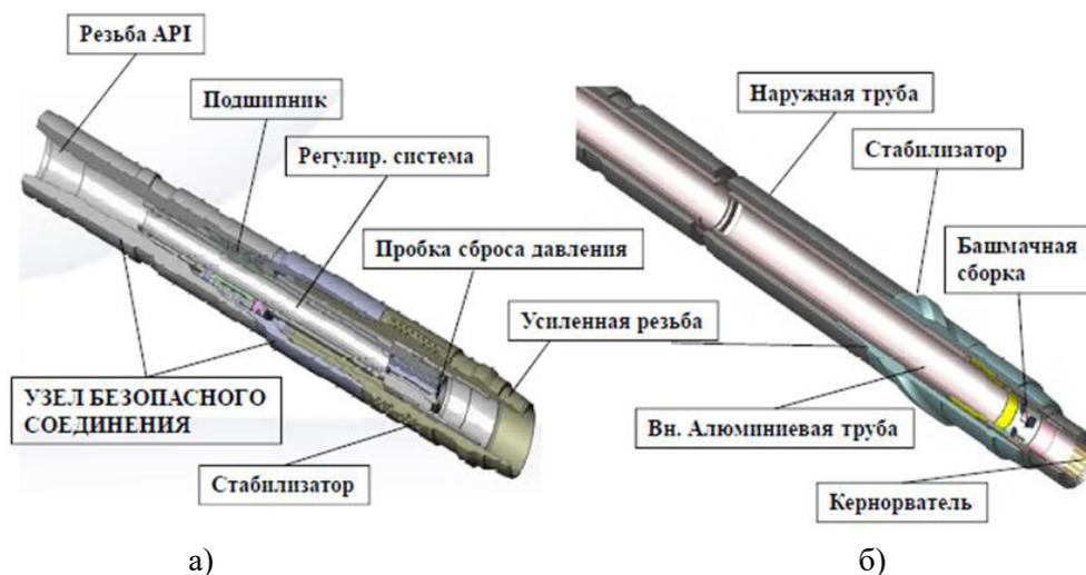
Рис. 1. Системы: а) регулируемая система внутренней сборки; б) система удержания керна
