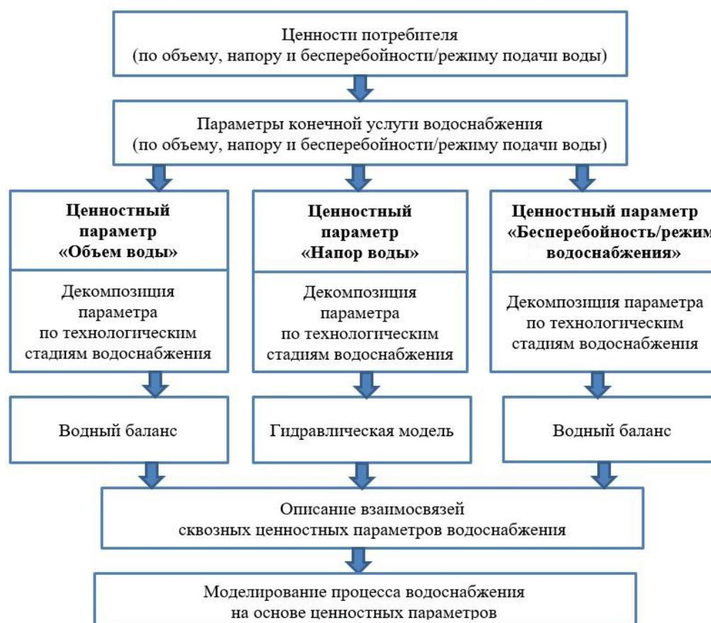
Рис. 1. Блок-схема структурно-параметрической идентификации процесса водоснабжения
