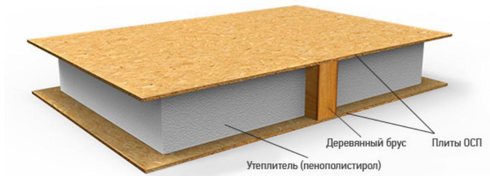
Рис. 1. Вид перекрытия из СИП-панелей
