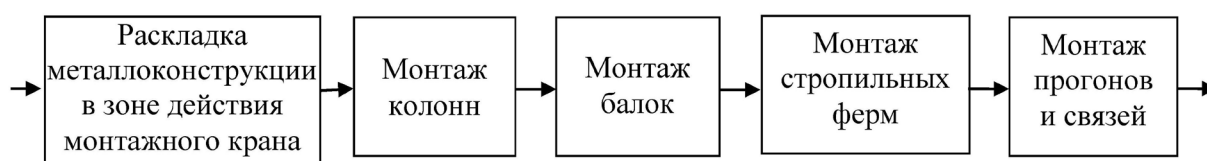
Рис. 1. Этапы процесса «Возведение фундамента и установка каркаса»
