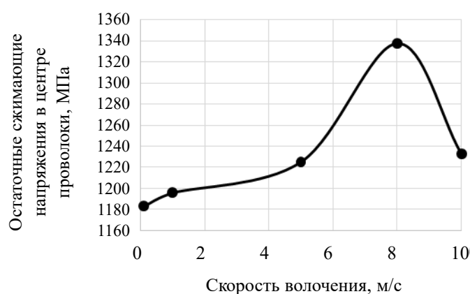
Рис. 1. Зависимость сжимающих остаточных напряжений в центре проволоки от скорости волочения
