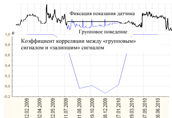
Рис. 2. Скользящее окно, выявляющее фиксацию сигнала датчика
