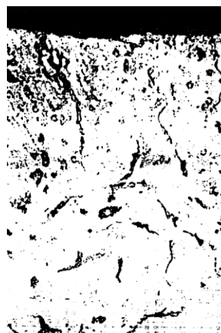
Рис. 2. Микроструктура поверхностного слоя графитизированного разжимного кулака тормоза автомобиля ЗИЛ-130 ( \times 300 )
