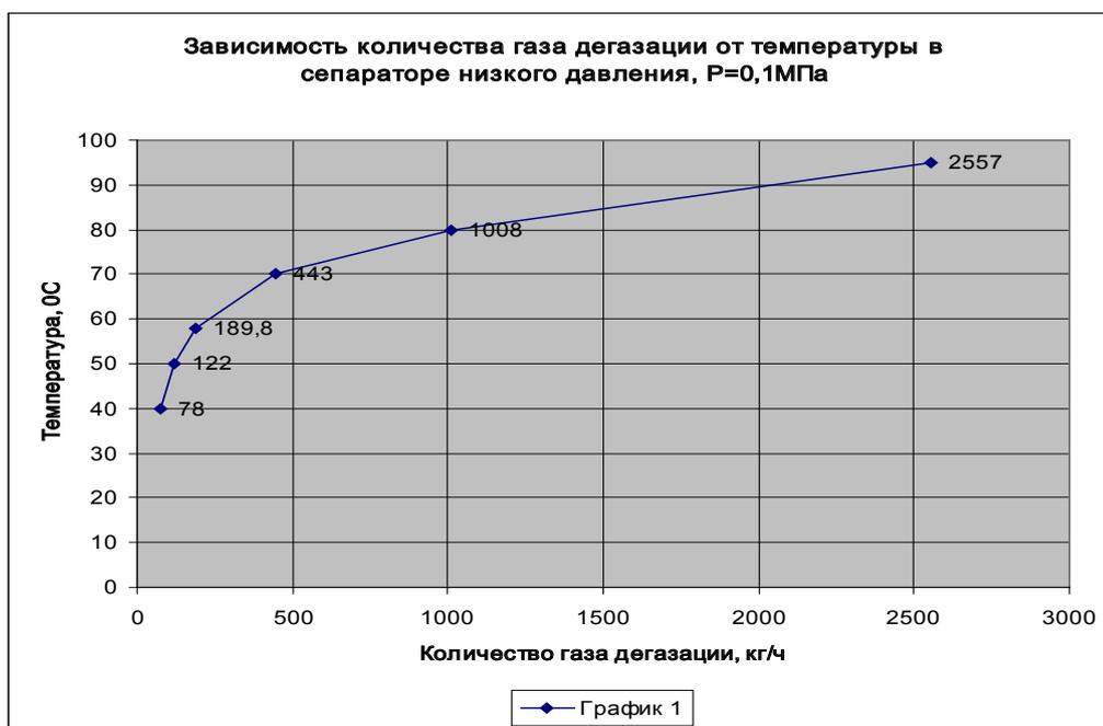
Рис. 1. График зависимости газа дегазации от температуры в сепараторе низкого давления
