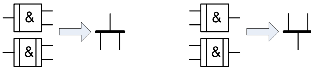
Рис. 1. Преобразование перекрестков разветвления и слияния типа «И» диаграммы IDEF3 в элементы «Развилка» и «Слияние» языка UML
