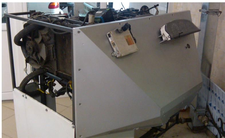
**Рис. 2.** Стенд на базе двигателя 4A-FE
