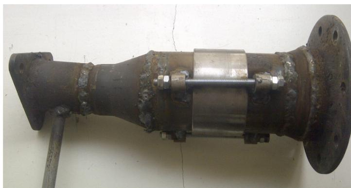
Рис. 3. Нейтрализатор выхлопных газов двигателя
