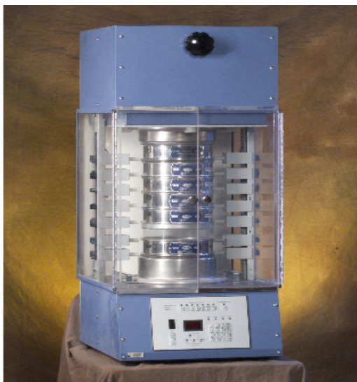
Рис. 1. Прибор для просеивания и фракционирования металлургических порошков
