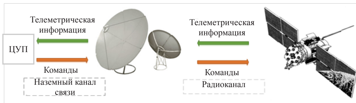
Рис. 2. Последовательность выдачи команд на КА
