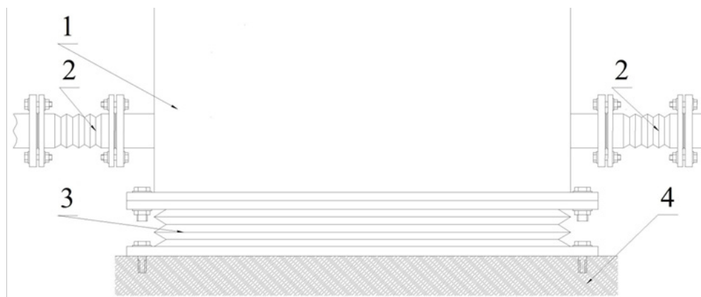
Рис. 1. Кожух ударного узла с отводящими патрубками:
