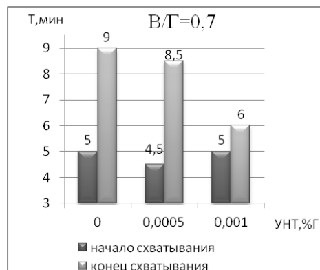
Рис. 6. Диаграмма начала и конца схватывания гипсового теста с различными концентрациями УНТ «Таунит» при B/G = 0,7
