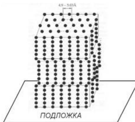
Рис. 1. Схематическое изображение двумерно-упорядоченного линейно-цепочечного углерода
