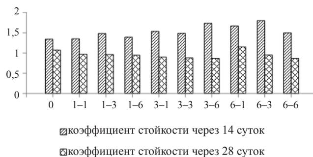
**Рис. 2.** Изменение коэффициента стойкости известковых композитов после выдерживания в модельной среде продуктов метаболизма мицелиальных грибов
