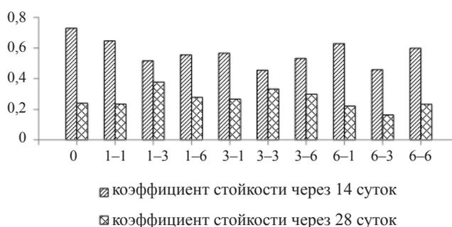
**Рис. 3.** Изменение коэффициента стойкости известковых композитов после выдерживания в модельной смеси продуктов метаболизма бактерий
