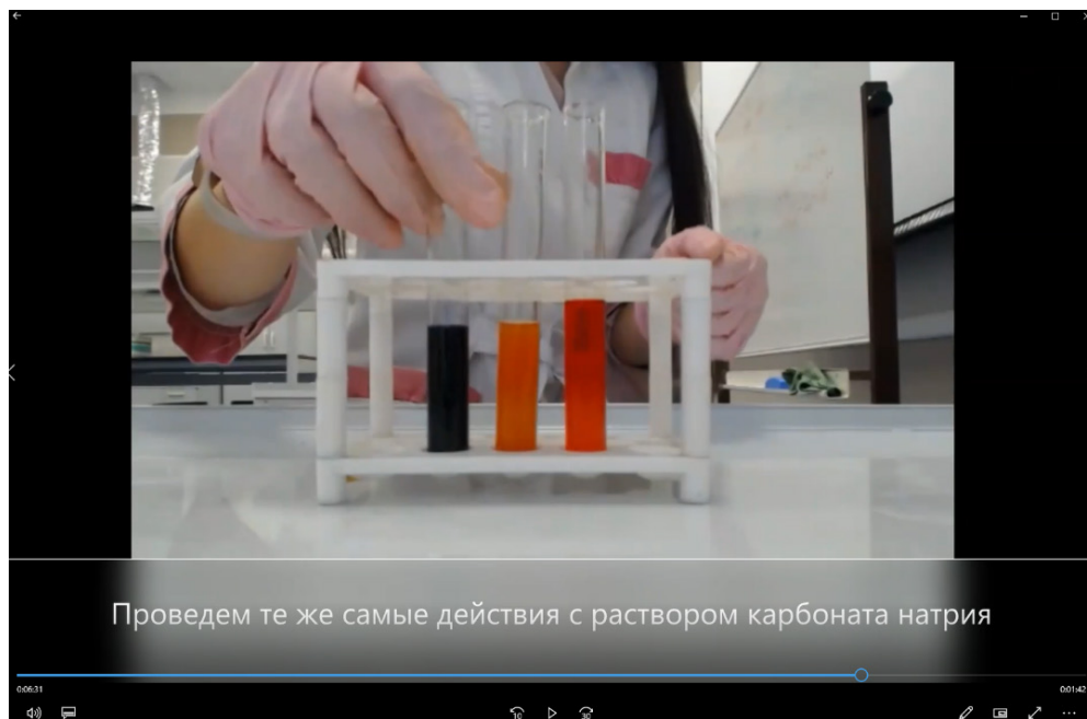
Рис. 3. Демонстрация изменения окраски универсального индикатора в зависимости от кислотности среды
