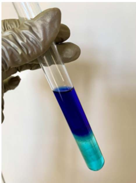
Рис. 1. Образование синего раствора комплексного соединения меди
